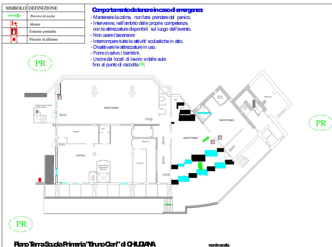
Figura 1. Pianta emergenza Piano Terra Scuola Primaria Chiugiana
